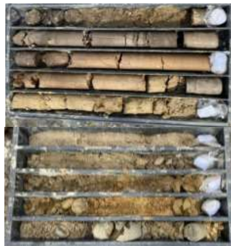
Figura 7. Fotografie din amplasament în timpul realizării forajului geotehnic și cu pământul rezultat în urma forajului
